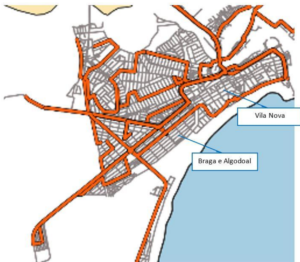
Figura 7. 18. Representação da falta de cobertura da rede de sistema de transporte público nos bairros Braga, Algodoal e Vila Nova e entornos.
