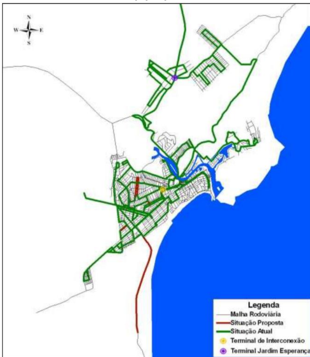
Figura 7. 11. Itinerário atendido pelo sistema de transporte coletivo no município de Cabo Frio em 2006 versus o sistema proposto pelo relatório
