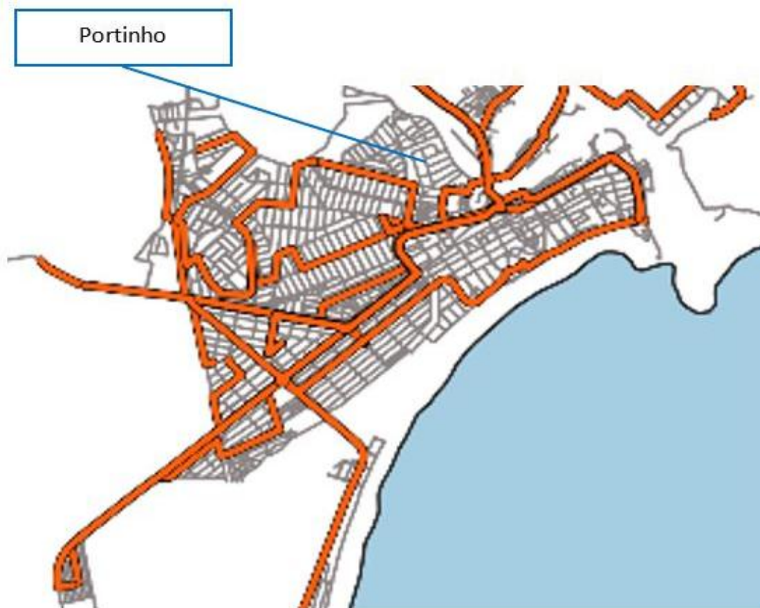
Figura 7. 20. Representação da falta de cobertura da rede de sistema de transporte público no bairro do Portinho e entorno.
