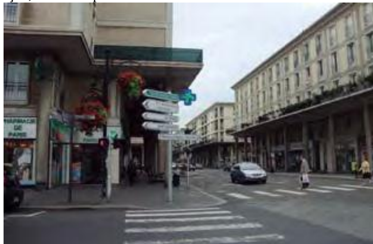
Figura: Sinalização, faixas de pedestres e rebaixamento de meio-fio. Le Havre, França, 2011.
