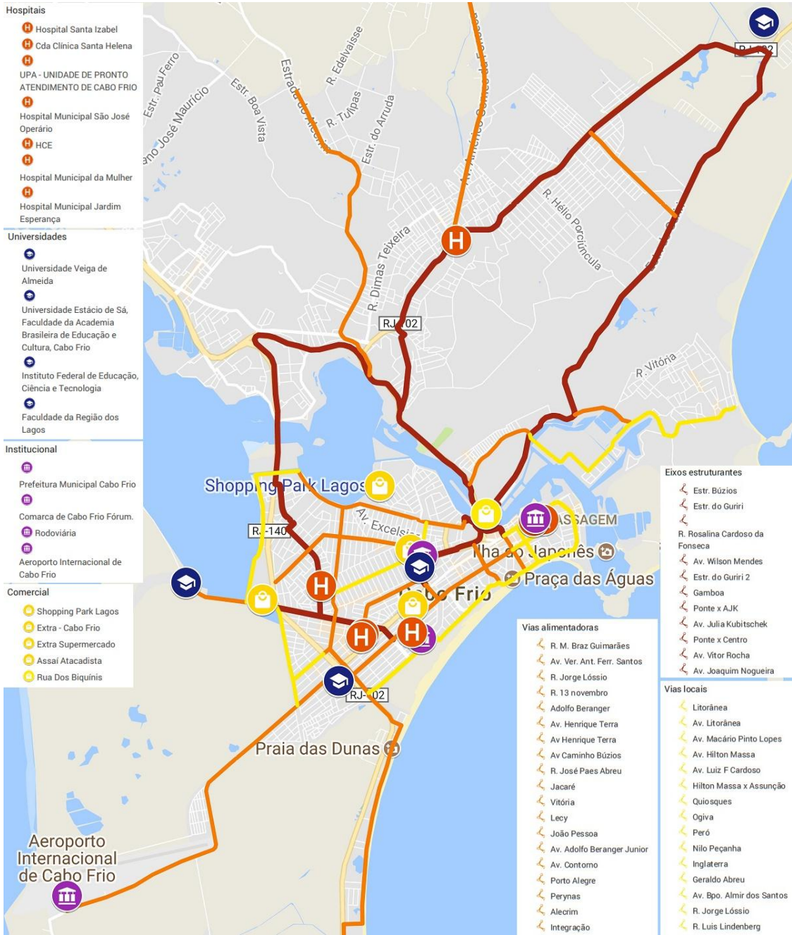
Figura 6.15. Rede cicloviária proposta, hierarquizada, eixos estruturantes, coletores e locais.
